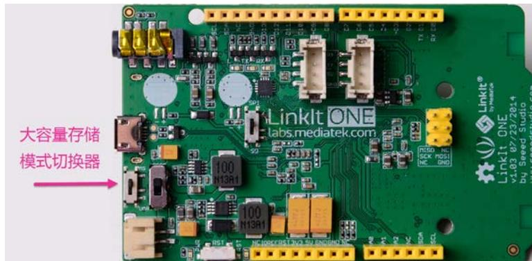
图 12 LinkIt ONE 大容量存储模式
